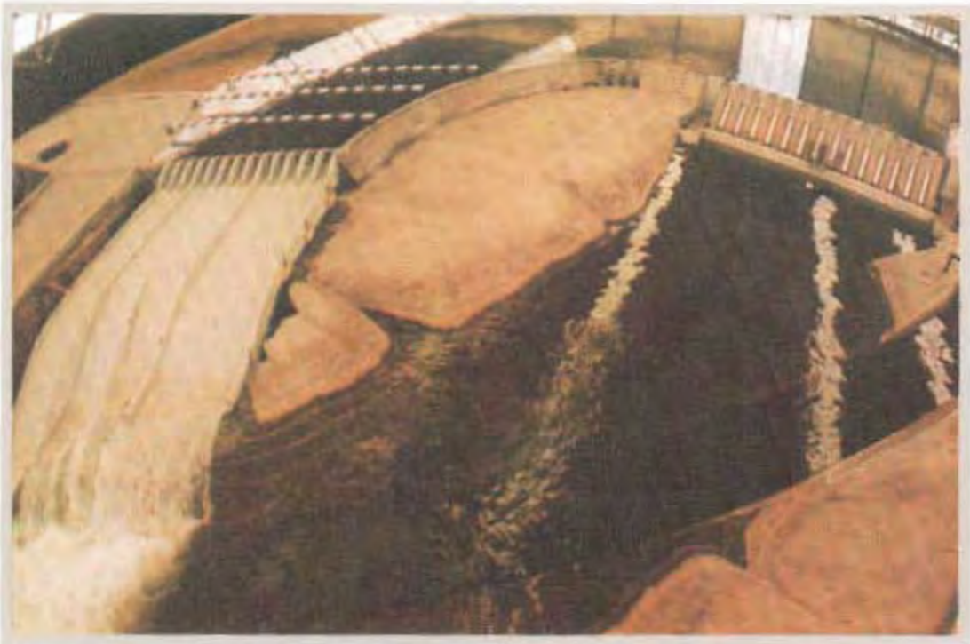
Modelo reducido de la Central Hidroeléctrica de Itaipú
